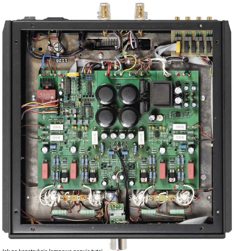
Jak na konstrukcję lampową panuje tutaj wyjątkowy porządek, większość elementów zmontowano na dużej płytce drukowanej.
